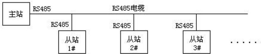
用 FS-BT485A 来实现 RS485 蓝牙无线多点组网通信方案如下图所示, 这种方案比蓝牙本身可实现的 1 主绑 7 从的多点通信方案更为简洁和使用方便, 每对绑定配对的 FS-BT485A 之间互不影响, 即绑定配对后的蓝牙模块之间就象一根导线。该方案不需改变原来的 RS485 通信协议和软件, 而且 RS485 站点的数量并不受限制, 与原来电缆通信时相同。
